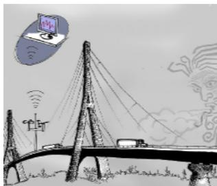
L'objectif des recherches financées par le programme WEATHER est le développement de systèmes d'alerte au vent pour les transports ferroviaires et routiers. Ces systèmes, basés sur des mesures météorologiques en temps réel, devront permettre d'évaluer le risque de renversement ou de perte de contrôle de trajectoire pour un véhicule s'engageant sur un parcours donné. Il devra être en mesure de déclencher une alerte sélective en fonction d'un risque admissible choisi par l'exploitant.
